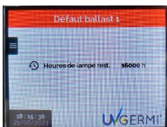
Le ballast N°1 est en défaut lors du démarrage de l'appareil ou quand l'appareil est en service.
