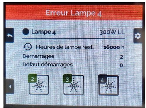
**Avertissement** Pour acquitter les défauts, il faut impérativement éteindre les lampes puis actionner le sectionneur sur 0. Attendre 30 S avant de remettre en marche les lampes.
